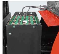
La batería puede retirarse hacia adelante, facilitando así el mantenimiento
